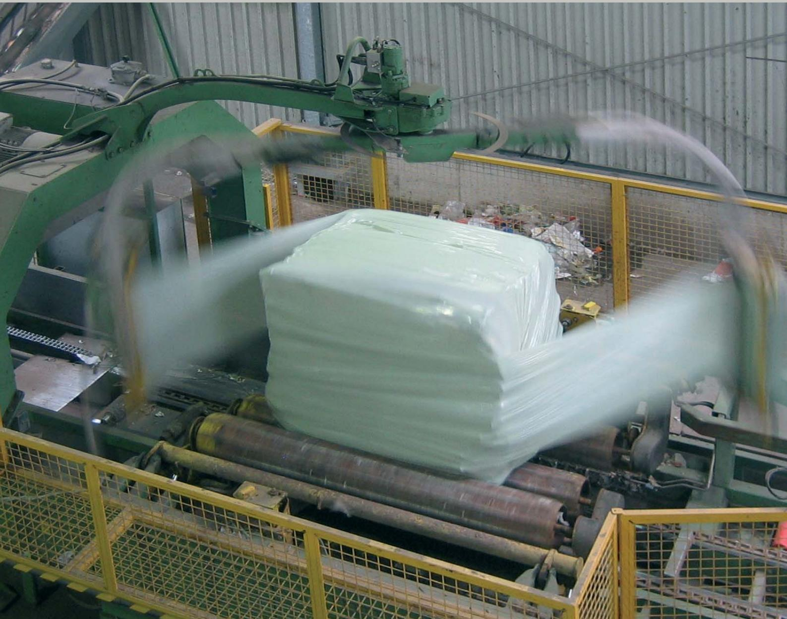
**W celu owinięcia kwadratowej lub sześciennnej beli, musi być ona obrócona wokół dwóch osi. W odróżnieniu od innych systemów owijania maszyna ROTOWRAP obraca belę dwuosiowo jednocześnie, co znacznie zwiększa wydajność.**
