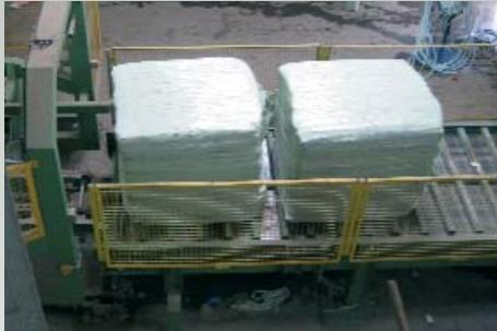
**ROTOWRAP-Maschinen arbeiten mit handelsüblicher 750mm breiter Stretchfolie.**
